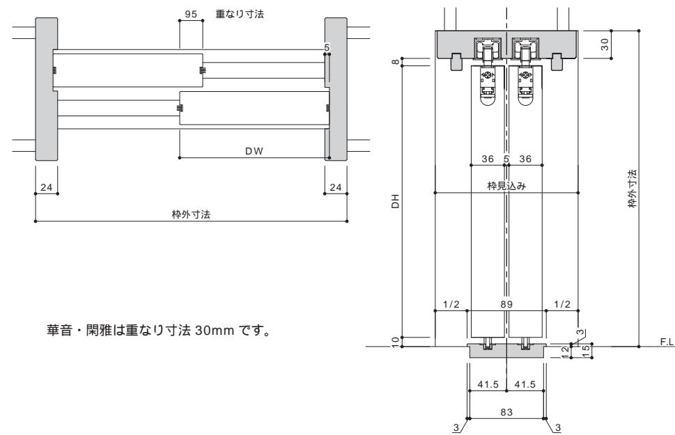
引違枠(上吊) 枠見込寸法は 155mm・170mm・185mm・195mm の4種類です。
