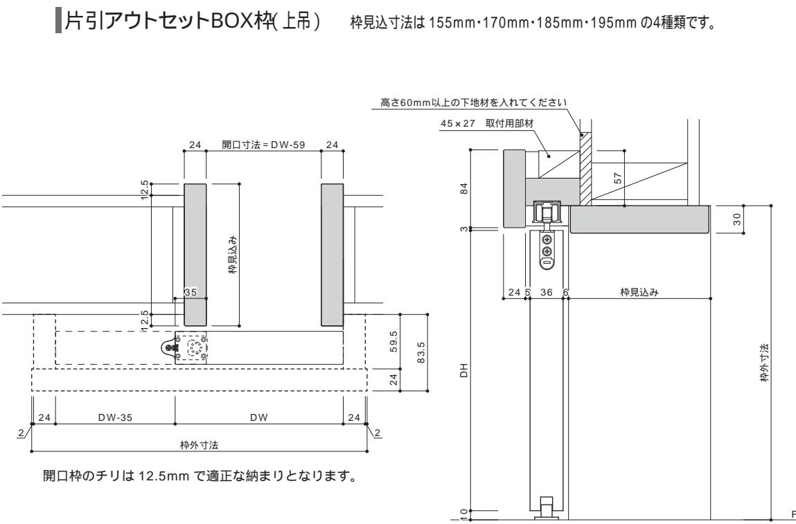
片引戸袋枠(上吊) 枠見込寸法は155mm・170mm・185mm・195mmの4種類です。
