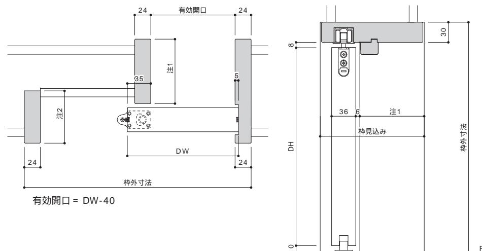
■片引アウトセット枠(上吊) 枠見込寸法は 155mm の1種類です。
