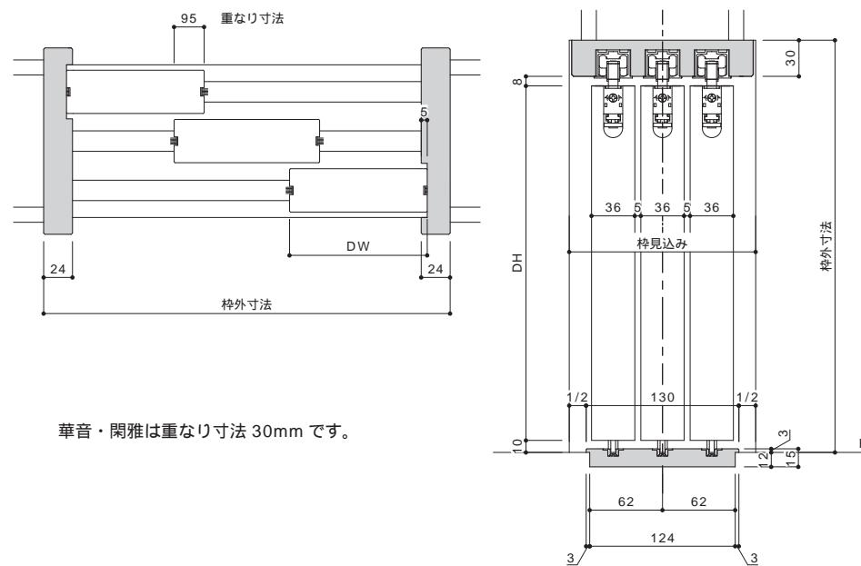
2枚引込枠(下荷重) 桁見込寸法は 155mm・170mm・185mm・195mm の4種類です。
